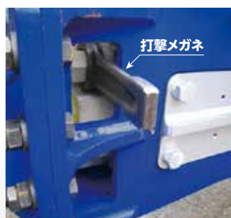
▲ サイドロッドの点検・増し締めが可能
