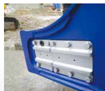
▲ メンテナンスがしやすい大きな点検口 (S-100以上)
