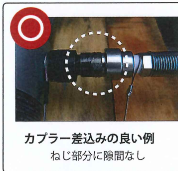
接続部分の取付の良い例 ねじ部分に隙間なし
