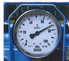
油圧ポンプの 最大圧力
