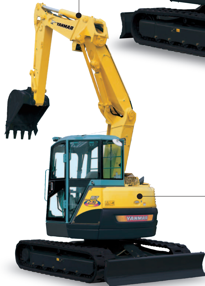
損傷しにくいブーム背面アームシリンダー
