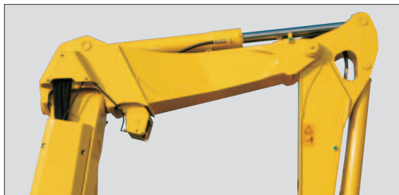
損傷しにくいブーム背面アームシリンダー
