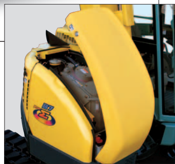
燃料給油口、バッテリーなどを収納したサイドボンネット
