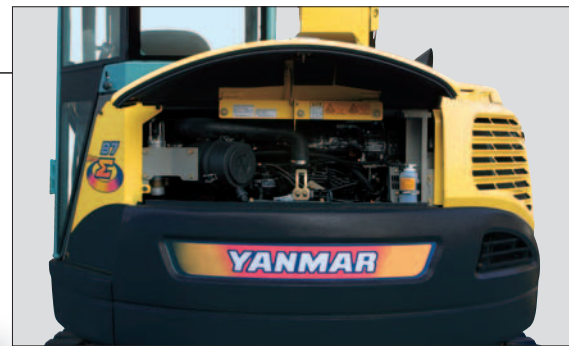
エンジンまわりの点検がラクにできるワイドリアボンネット
