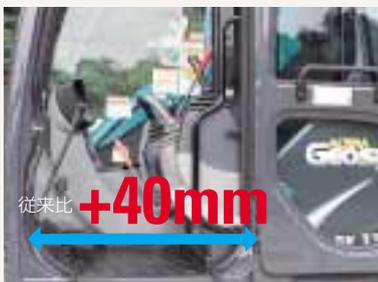
ドア開口幅を40mm拡大(従来機比)。乗降遮断式レバーロックと連動した左コントロールボックスの跳ね上がり角もワイド。ドアハンドル高さも開閉しやすさに配慮した乗降しやすいキャブです。
