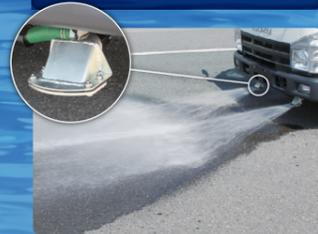
圧力水で洗浄作業ができます。
