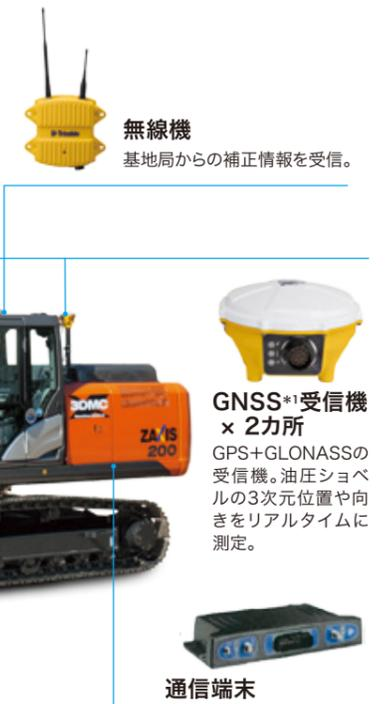
\*1GNSS(Global Navigation Satellite System): GPS、GLONASSなどの人工衛星を用いて機械の位置、方向を検出する方式
