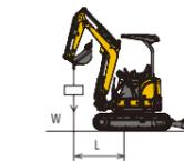
※右表に示す定格荷重は、水平堅土上定置荷役における値で、転倒荷重の78%以内、および移動式クレーン構造規格で定める前方安定度を満足するものです。※吊り荷走行時の定格荷重は定置吊り時の50%になっています。作業範囲にも制限があります。
