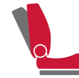
5 リクライニング+スライドシート オペレーターの身体の大きさや姿勢に合わせて調整可能です。
