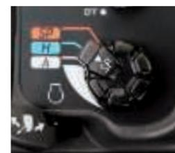
スロットルレバー型モード切替機構 ボリュームを回すだけでスロットルが連動、誰でも簡単に最適な作業性能が選択できます。
