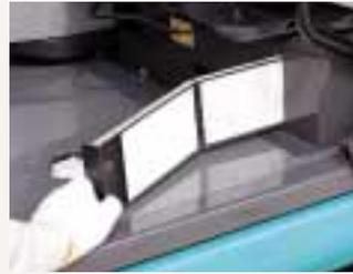
●内気/外気とも工具なしで取り外せるエアコンフィルタ(写真は内気フィルタ)。
