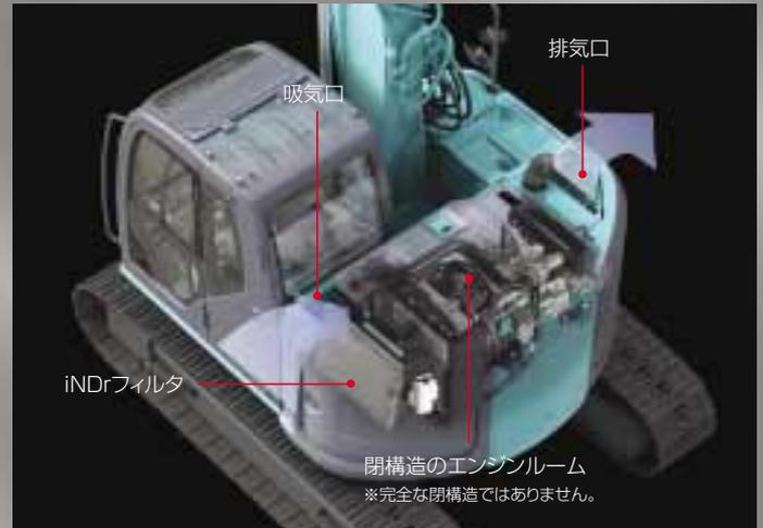
吸気口から排気口までを一本のダクトに見立て、その内部をエンジンルームとした構造のiNDr。ダクトの壁に隙間をつくらず、同時に直角コーナーを設けることで、運転音の漏れを極小に。またiNDrフィルタにより優れた防じん性を発揮。信頼性と整備性の飛躍的向上につながりました。発想に、メカニズムに、効果に驚かすにはいられない新冷却システムです。
