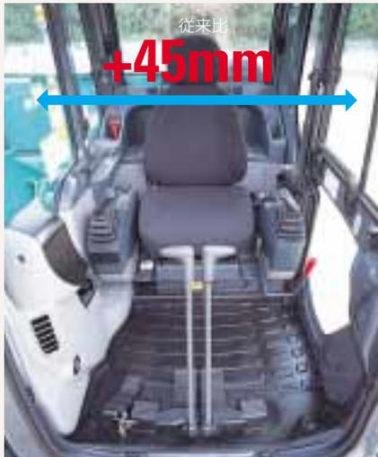
中大形通常形モデルに搭載したキャブと同じ幅と高さを実現したビッグキャブを搭載。オペレータ前方にスペースを確保してゆとりある操作空間を実現。フロアも広く足元も快適です。
