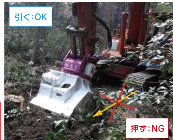
バケットを傾けた状態で岩等を叩くと、爪1本に過大な力がかかるて爪が破損する恐れがあります。また切株を爪で叩き割る動作は、爪が折れたり、ローターラの旋回輪が破損する恐れがあります。
