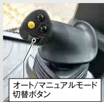
オート/マニュアルモード切替ボタン 作業装置レバー（座席右側）
