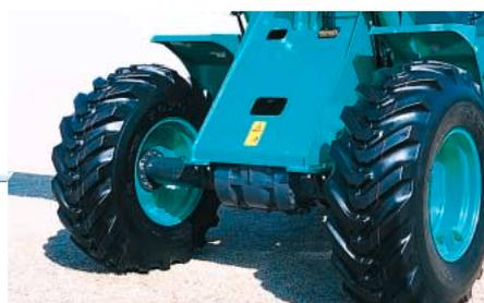
走行ブレーキには油圧作動の密閉湿式ブレーキを採用。泥濘や水たまりなど悪条件下でも安定した制動力を発揮。冰雪などによる凍結の心配もありません。全油圧式独立2系統のブレーキ回路は、万一どちらか一方に不具合が生じた場合でも制動力を保持します。
